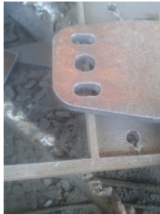
정품 Cu+ 소모품으로 절단 시 구멍과 슬롯 절단 품질이 향상되었습니다.
